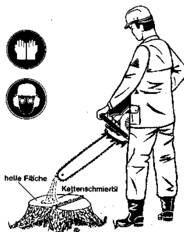
Kontrolle der Kettenschmierung
